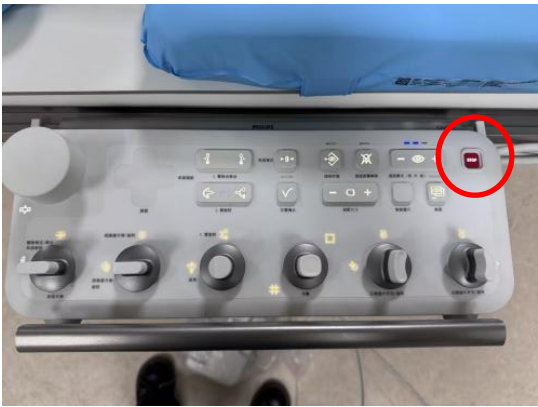
图3-7 DSA设备床旁操作台急停按钮
